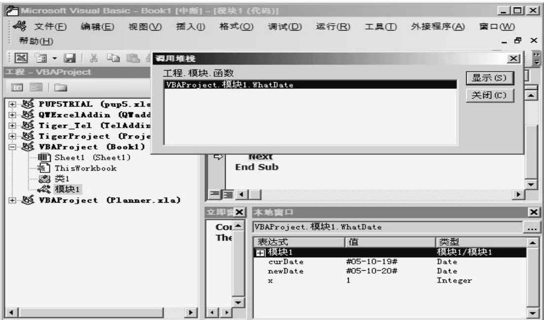
图13-13 调用堆栈对话框显示了开始但未完成的过程列表 调用堆栈对话框特别是在追踪嵌套的程序时有用。回想一下，嵌套过程是一个被另一个过程调用的过程。如果一个过程调用另一个过程，该被调用的过程名称就会自动添加到调用堆栈对话框里的调用列表。当VB执行完该被调过程后，该过程名称就会从调用堆栈对话框里自动清除。你可以使用调用堆栈对话框上的显示按钮，显示调用下一个过程的语句。
