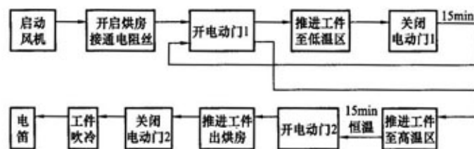
图 336 热处理车间烘房的工艺流程
