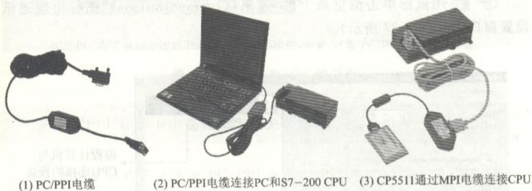
图 2-35 S7-200 的编程电缆
