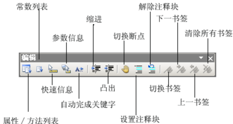
图2—11 编辑工具条上的按钮使得编写程序和设置指令格式变得很容易
