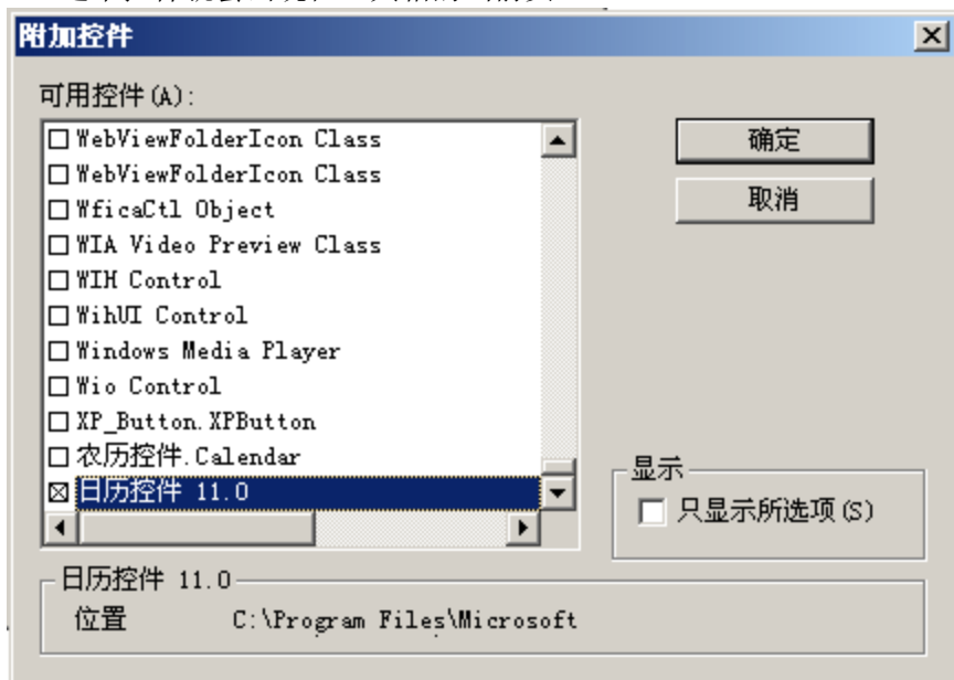
图10-10 你在工具箱上附加额外安装在你电脑上的ActiveX控件
